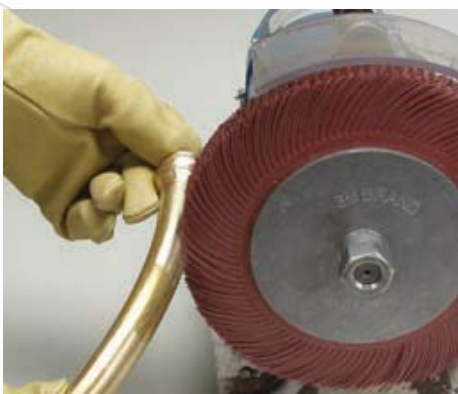
Очистка и восстановление поверхности
